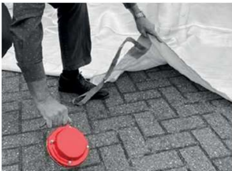
Plasati/aruncati unitatea de aerosoli sub masina/patura, cat mai aproape de baterie posibil.
