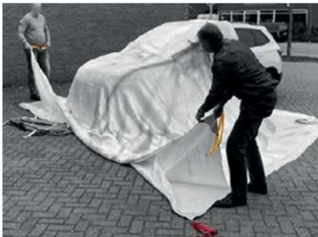
Acum trageti cealalta jumatate a paturii peste masina folosind bucelele (galbene)
