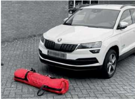
Asezati patura izolatoare de foc FI-BL0906 în fata masinii.
