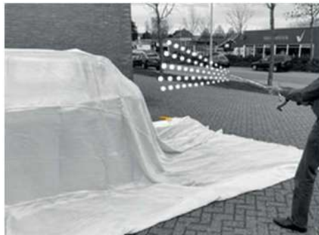
Stropiti ceata de apa peste masina/patura - 2
