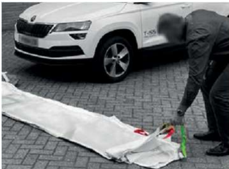
Trageti jumatate din patura peste jumatatea masinii folosind bucelele (verzi).
