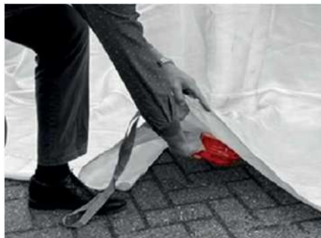
Plasati/aruncati unitatea de aerosoli sub masina/patura, cat mai aproape de baterie posibil.
