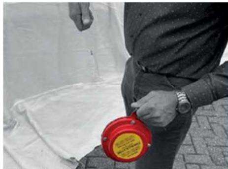
Activati unitatea de aerosoli tragand de coarda.
